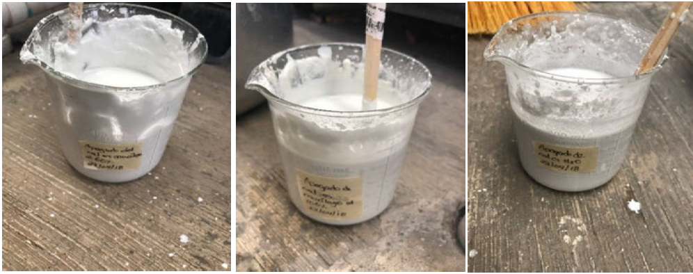
Fig. 2 Proceso de hidratación de óxido de calcio para la producción de hidróxido de calcio o cal hidratada en pasta empleando mucílago de nopal como agente hidratante en concentraciones del 20, 60 y 100 %
