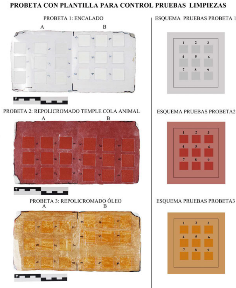
Fig. 2 Selección, distribución y sistema de control de las pruebas de limpieza en cada probeta
