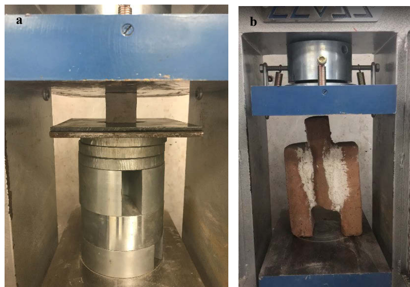
Fig. 6 a) Probeta cúbica sometida a compresión para medir su resistencia al aplastamiento y comparar el comportamiento entre los morteros preparados a partir de las distintas pastas de cal producidas y los diferentes roles del mucílago de nopal. b) Probeta propuesta en un tercio de ladrillos en posición vertical sometida a fuerza de compresión para determinar la resistencia que ofrece el mortero de unión en su papel adhesivo entre unidades mampostería. Ambas pruebas se llevan a cabo en una máquina universal de pruebas tipo prensa manual digital modelo E657-2 con alcance de medición de 120 toneladas
