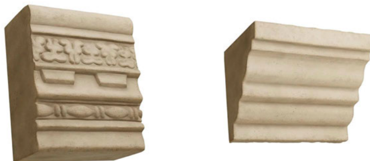
Fig. 4. Modelado 3D de modelos tipológicos a partir de los modelos fotogramétricos de los fragmentos de cornisas
