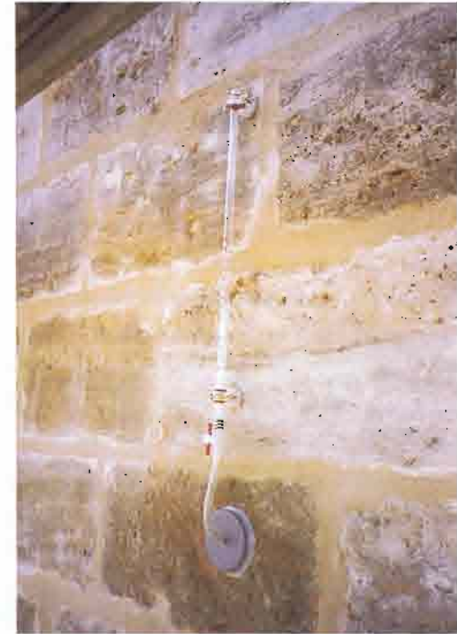
43. Ensayo de absorción con Probeta de Kaarstens
