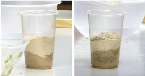
La tierra absorbe agua por capilaridad. Con un sencillo experimento es posible mostrar este fenómeno. El agua por capilaridad puede afectar a la resistencia del muro. Para ello se debe proteger la base del muro con otros materiales que resistan mejor este fenómeno, como la piedra.
