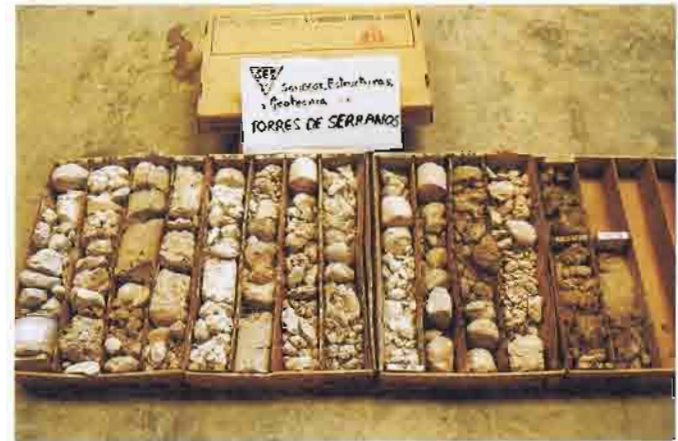
113b. Testigo continuo del subsuelo de las Torres de Serranos
