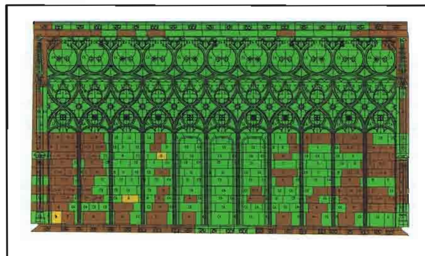
47. Plano de hipótesis constructivas de la tracería
