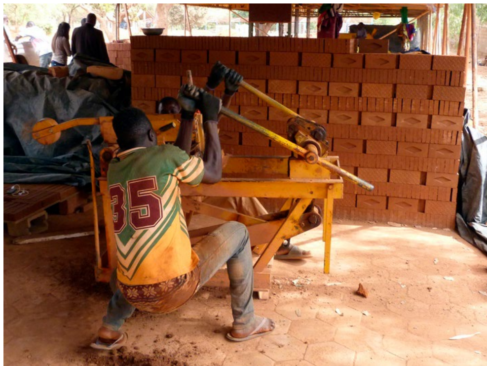
Figura 1. Blocadora manual para la producción de BTC en Ouagadougou.
